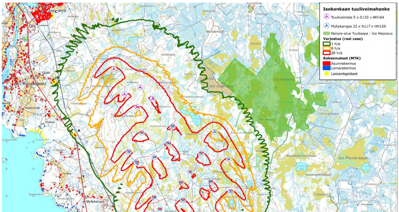
Kuva 24. Varjostusmallinnus, Gamesa G132. Isokankaan voimalan napakorkeus on 164 metriä ja kokonaiskor- keus 230 metriä. Myllykankaan voimalat on mallinnettu voimalalla jonka roottorin halkaisija on 117 metriä ja napakorkeus 120m.
