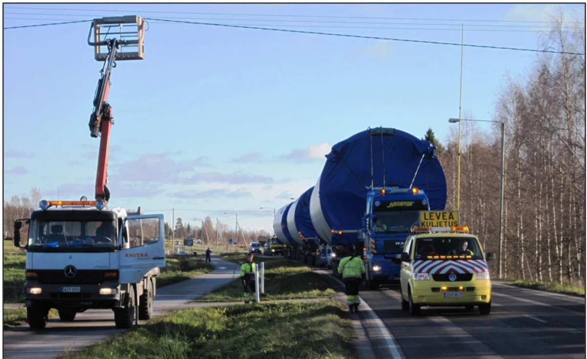
Kuva 122. Tuulivoimalan tornin osien erikoiskuljetus (Etelä-Pohjanmaan ELY-keskus).
